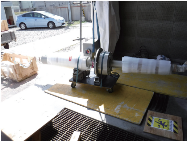
(写真4) 台車に乗せ、ラッシングベルト等で固定
