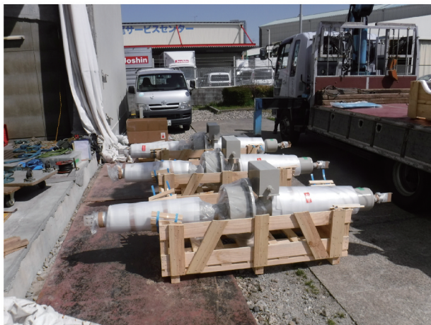
(写真1) 納入されたブッシング、梱包上半分解体
